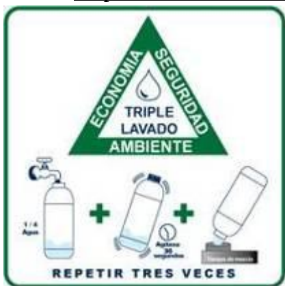
Figura 9. Procedimiento para realizar el triple lavado en embases de agroquímicos.
