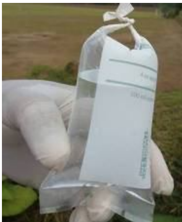
Figura 11. Muestra de agua para análisis microbiológico con cámara de aire.
