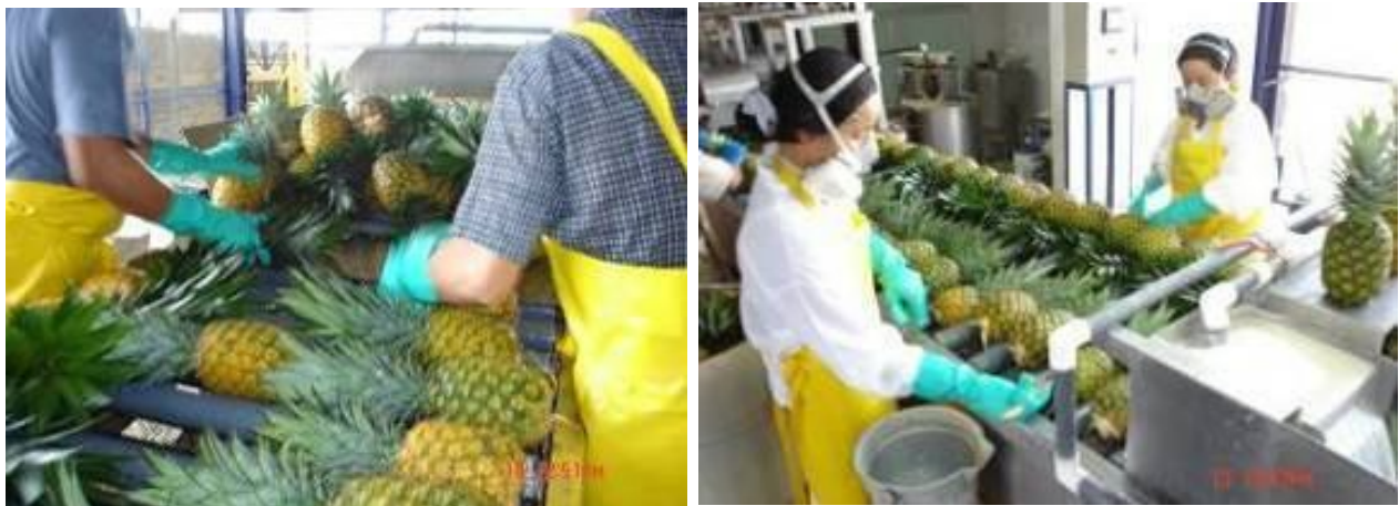
Figura 48. Selección de frutas y aplicación de cera y fungicidas.
