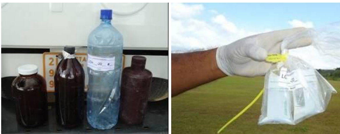
Figura 10. Diferentes frascos utilizados en el muestreo de plaguicidas en agua (izquierda), muestra de agua etiquetada y embolsada adecuadamente para su envío (derecha).
