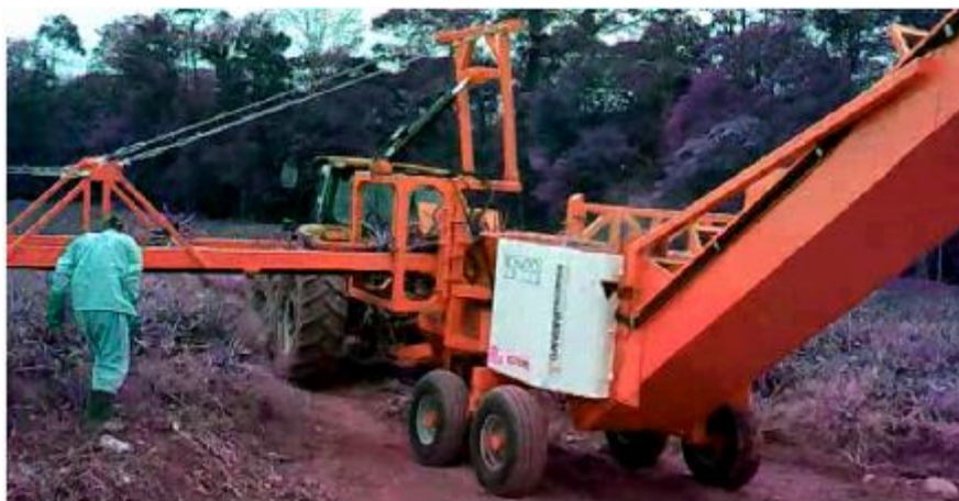
Figura 16. Carreta trituradora modificada don dos bandas giratorias, para la recolección del rastrojo del campo y su colocación en una carreta para su transporte.
