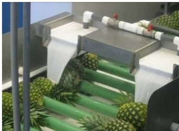
Figura 49. Aplicación de cera en forma de cascada sobre las frutas de piña.
