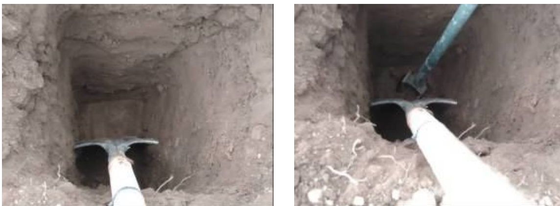
Figura 13. Limpieza del piso de muestreo (izquierda), toma de muestra de suelo a profundidad (derecha).
