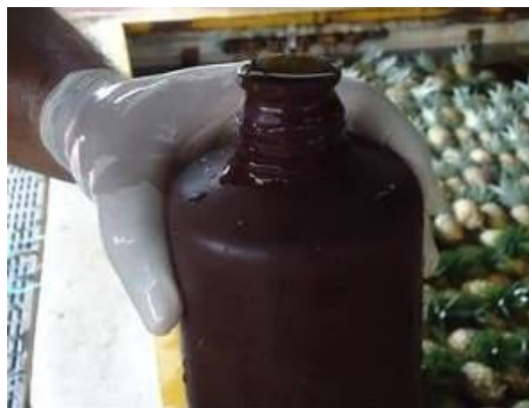
Figura 12. Botella completamente llena sin burbujas de aire.
